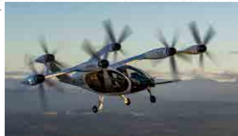
ANAホールディングスと協業する、米ジョビー・アビエーションの「Joby S4」。固定翼がついた推力偏向と呼ばれるタイプで、5人乗り。海外機として初めて日本の型式証明を申請している。 ©Joby Aviation
